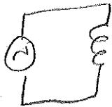
$$V_L = L \frac{dI}{dt} V_0 e^{i\omega t}$$
