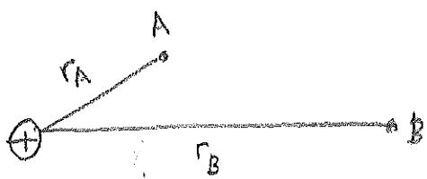
$$V_B - V_A = - \int_A^B \vec{E} \cdot d\vec{r} \quad \text{where } |\vec{E}| = \frac{kq}{r^2}$$
