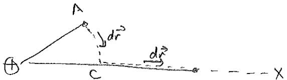
$$b) V_B - V_A = - \int_A^C \vec{E} \cdot d\vec{r} - \int_C^B \vec{E} \cdot d\vec{r} = - \int_{r_A}^{r_B} E_x dx$$
